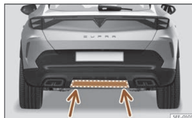
Fig. 87 Zona de detección del sensor inferior
