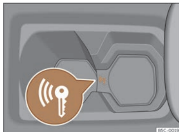
Fig. 122 En la consola central: arranque de emergencia.
